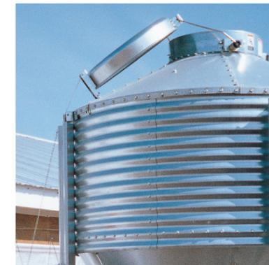
**ESTÁNDAR** – Nuestro sistema de tapa y apertura de silo de alimento **SPRING-LOCK®** (patentado) ayuda a conservar la bioseguridad, permitiendo que los silos puedan abrirse desde una ubicación remota. Los silos se abren fácilmente con una sola mano, y cuentan con una característica de acción positiva de cerrado impulsada por resorte. Cuando está abierta, la tapa se desliza hacia abajo y fuera del paso del sinfín del camión de alimento.
