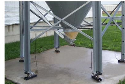
**El sistema mecánico WEIGH-MATIC® de Chore-Time** usa una balanza de astil de alta fiabilidad, incorporada al silo de pesaje, para dosificar la cantidad de alimento que se seleccione.
