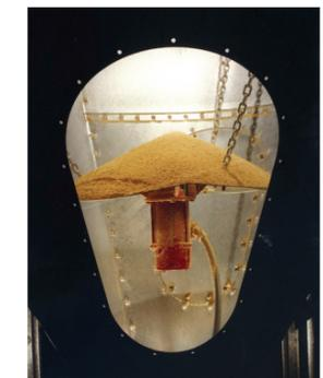
**OPCIONAL** – El innovador control de flujo de material **SHAKER-PLATE®** de Chore-Time queda suspendido en el interior de la tolva del silo de alimento. La unidad **SHAKER-PLATE** vibra para generar el flujo de masa en el alimento almacenado. La unidad, de funcionamiento económico, se activa automáticamente cuando el sinfín de descarga está funcionando.
