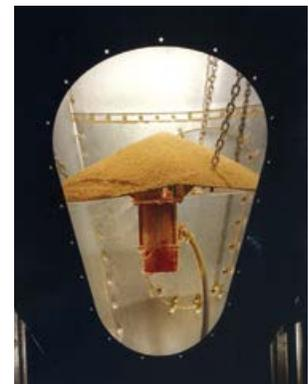
**OPZIONALE – L'innovativo dispositivo di controllo del flusso di materiale SHAKER-PLATE® è sospeso all'interno della tramoggia del silo mangime. L'unità SHAKER-PLATE vibra per creare un flusso di massa per il mangime stoccato. L'unità gestibile in modo economico si attiva automaticamente quando è in funzione la spirale di scarico.**
