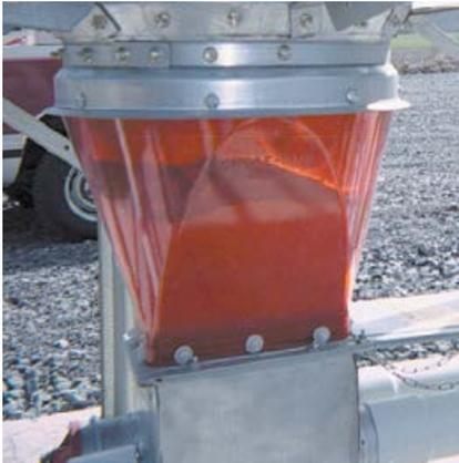
**STANDARD con qualsiasi modello di FLEX-AUGER® o spirale ad anima spessa da 102 mm (4 pollici) – Il raccordo del pozzetto in policarbonato traslucido rosso di Chore-Time offre un'elevata robustezza e resistenza all'impatto. Disponibile in configurazioni dritte e a 30 gradi, il raccordo si adatta a gran parte dei silos mangime esistenti di produzione meno recente con aperture di tramoggia da 406 mm (16 pollici). È anche disponibile un modello opzionale trasparente.**
