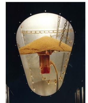
**OPZIONALE – L'innovativo dispositivo di controllo del flusso di materiale SHAKER-PLATE® è sospeso all'interno della tramoggia del silo mangime. L'unità SHAKER-PLATE vibra per creare un flusso di massa per il mangime stoccato. L'unità gestibile in modo economico si attiva automaticamente quando è in funzione la spirale di scarico.**
