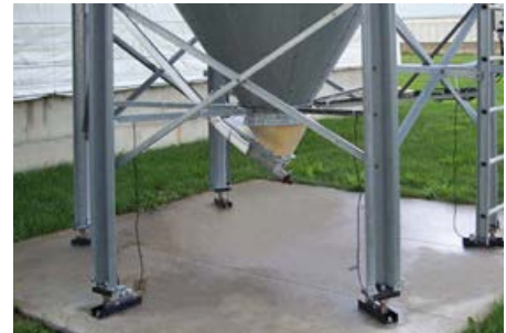
Weegcellen verwerken tot 4500 kg (10.000 pond) per silopoot.
